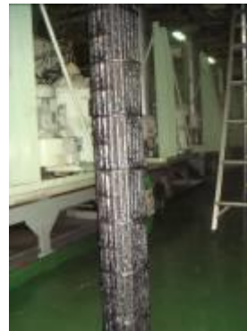
兩台電機滑油淨油機,加熱器盤管髒污嚴重
