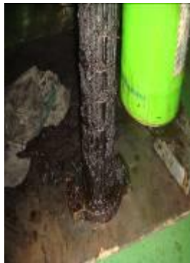
兩台電機滑油淨油機,加熱器盤管髒污嚴重
